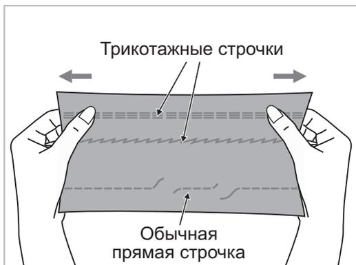
Трикотажная строчка – является прочной и эластичной. Рекомендуется использовать ее при работе по трикотажным тканям, а также для сшивания плотных тканей, таких как, например, джинсовая ткань.
