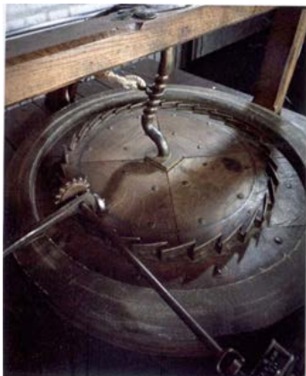
Рис. 1 Машина для заточки швейных игл, сконструированная Леонардо да Винчи
