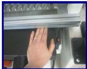
С усилием вставьте сверлильную головку в шпиндель и давите вниз, затем вращайте до тех пор, пока фиксация не будет воспринята автоматической системой блокировки. Для демонтажа вставьте узкую отвертку в пространство между сцеплением и шпинделем и создайте небольшое усилие рычага, чтобы извлечь сверло.
