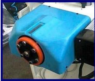
Устройство, которое позволяет производить настройку глубины сверления, состоит из барабана с револьвером. Данная система, которая ввиду того, что она имеет 6 различных позиций сверления, как правило после настройки больше не регулируется оператором, если он намерен изменить глубину сверления, если оператор хочет изменить глубину сверления, то он должен вращать барабан и при этом – всегда при выключенном состоянии станка- быстро переходить от одного упора к другому.
