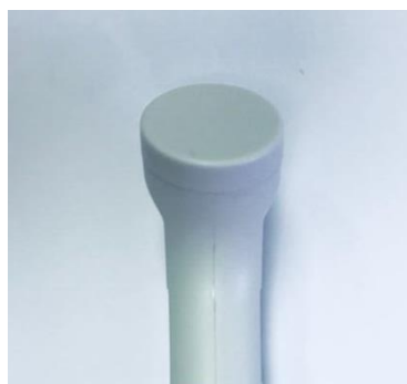
Рис. 3.7 Рабочая часть (линза) датчика УЗК фетального доплера в варианте исполнения Sonoline C
