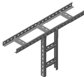
Рис. 22 Пример опуска лотка при помощи соединителя поворотного
