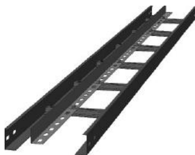
Рис. 20 Установка разделителя в лоток
