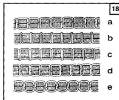
На Рис. 18 показаны различные виды строчки. Нормальная строчка должна выглядеть, как показано на Рис. 18а. В случае ненормально выглядящей строчки, сморщивания ткани и частых обрывов нити необходимо соответствующим образом отрегулировать натяжение верхней (игольной) и нижней нитей.
