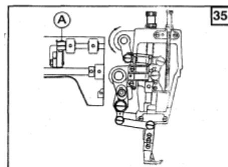
При необходимости отрегулируйте высоту подъема внутреннего и наружного прижимов в соответствии с видом материала. Для средних материалов высота подъема наружного прижима должна быть менее 5,5 мм. В целом сумма высот подъема наружного и внутреннего прижимов остается постоянной: при увеличении первой вторая уменьшается и наоборот.
