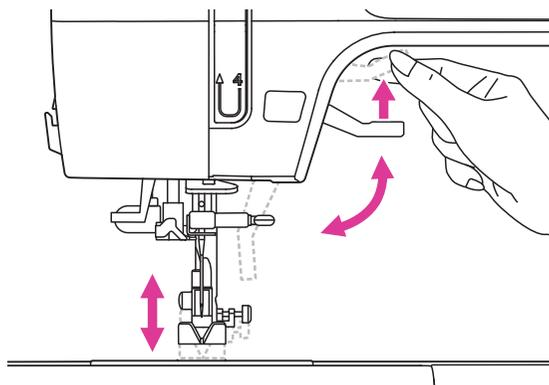
Рычаг подъема прижимной лапки используется для подъема или опускания лапки.
