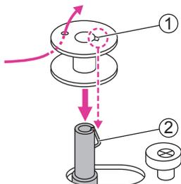
4. Протяните конец нити сквозь одно из внутренних отверстий в шпулке, как показано на рисунке, и наденьте ее на шпиндель для намотки шпульки. Совместите риску на шпулке с пружиной шпинделя.
