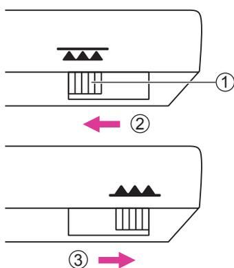
Рычаг отключения транспортера ткани расположен на задней части машины.
