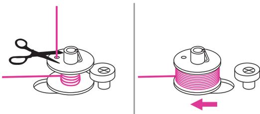
8. После намотки нескольких оборотов остановите машину и обрежьте конец нити как можно ближе к отверстию в шпулке. Продолжите процесс намотки, пока шпулка не заполнится. После заполнения шпулки ее вращение замедляется. Остановите машину, отпустив педаль, затем отведите шпиндель намотки шпульки влево.
