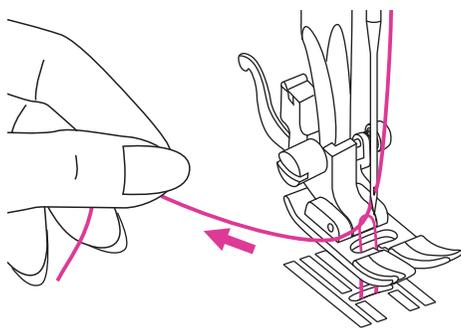
Осторожно потяните верхнюю нить, чтобы поднять шпульную нить через отверстие в игольной пластине. Шпульная нить поднимется в форме петли.
