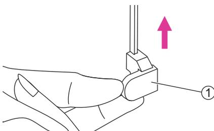
Поднимите рычаг подъема прижимной лапки и обрежьте нити. Для повторного обметывания той же петли поднимите рычаг подъема прижимной лапки (он вернется в исходное положение).
