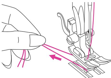
Протяните обе нити назад под нижней поверхностью прижимной лапки.
