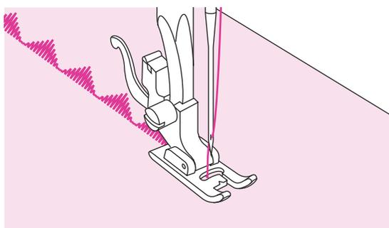
Лапка имеет паз на нижней поверхности, что позволяет плотной строчке свободно перемещаться под лапкой.
