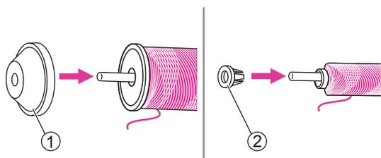
3. Наденьте катушку с нитками на катушечный стержень и закрепите ее при помощи держателя подходящего размера.
