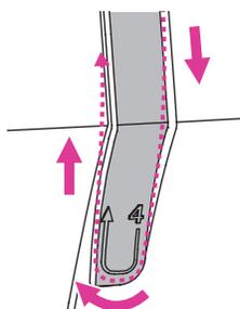
7. Проведите нить под пружиной нитепритягивателя, затем протяните ее вверх в направлении стрелок (см. рис.).
