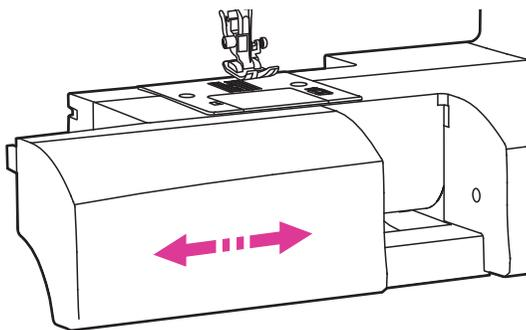
Удерживая съемный столик в горизонтальной плоскости, потяните его влево для отсоединения от машины.
