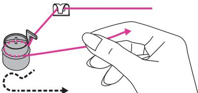
3. Обмотайте нить вокруг диска натяжения намотки шпульки по часовой стрелке.
