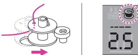
5. Отведите шпиндель намотки шпульки вправо. Когда шпиндель намотки шпульки отведен вправо, на экране отобразится указанный символ.
