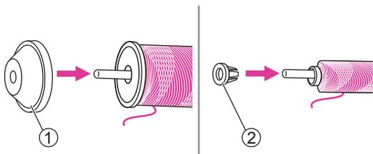
1. Наденьте катушку с нитками на катушечный стержень и закрепите ее при помощи держателя подходящего размера.
