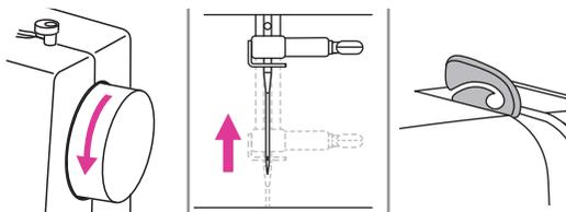
2. Вращая маховое колесо на себя, поднимите иглу и рычаг-нитепритягиватель в крайнее верхнее положение.
