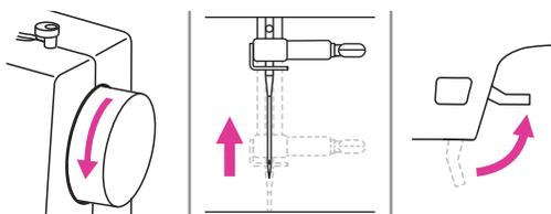
8. Поверните маховое колесо на себя (против часовой стрелки) и поднимите иглу. Поднимите подъемный рычаг прижимной лапки и вытащите ткань.
