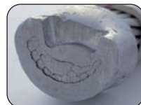
Срез гильзы, опрессованной клиновидными матрицами
