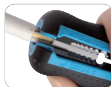
Снятие оболочки кабеля
