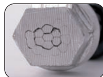
Срез гильзы, опрессованной гексагональными матрицами
