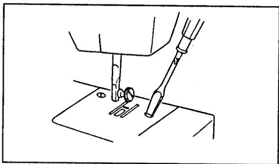
Снять иглу и нажимную лапку.
