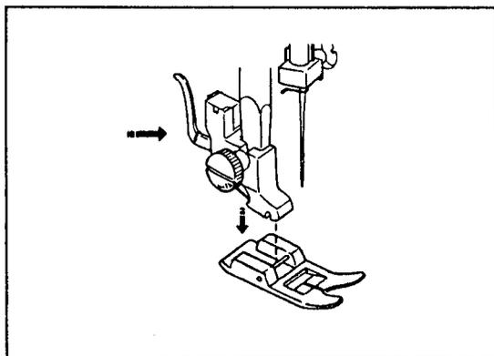
При креплении нажимной лапки, заранее установить кнопку регулятора давления лапки в нажатое, крайнее нижнее положение.
