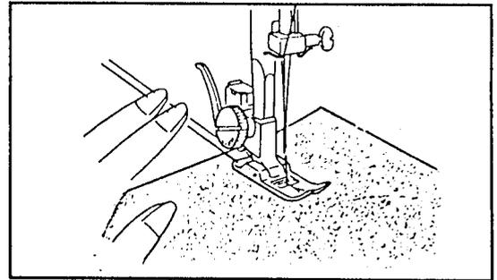
Поднять нажимную лапку и расположить сшиваемую ткань рядом с контрольной линией игольной пластинки.
