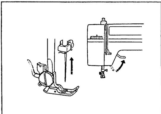
Поворачивая маховое колесо в направлении к себе, поднять швейную иглу вверх до ее крайнего верхнего положения.
