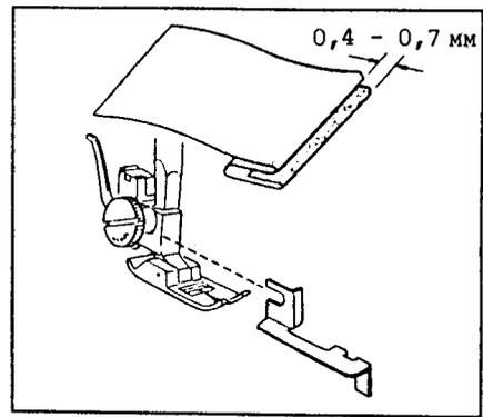
Подгибать ткань вкладку на требуемую ширину и прикрепить ее шпилькой. Затем перегибать подогнутый край, как показано выше. Опустить нажимную лапку, затем ослабить затяжку винта крепления держателя лапки и установить специальное загибочное приспособление размещена в середине носиков нажимной лапки.
