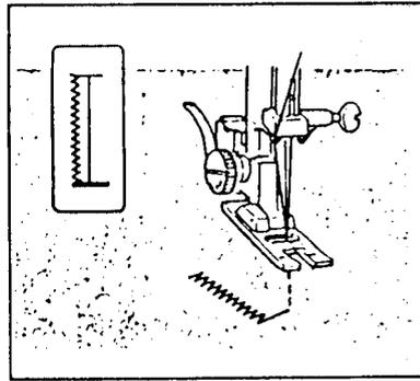
Установить ручку регулировки ширины строчки в положение "5", выполнить 5 стежков закрепки конца петли и поднять иглу из ткани.
