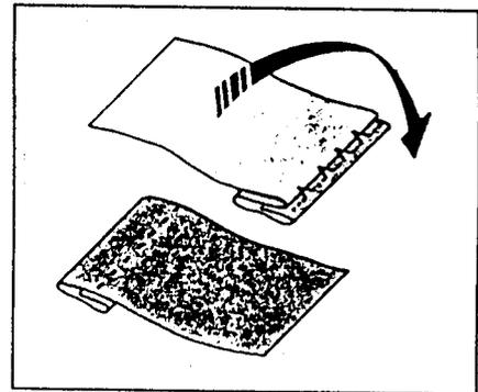
Поднять нажимную лапку и разместить ткань под лапкой, чтобы первый сгиб опирался на стенку приспособления. Опустить лапку и выполнить зигзагообразную строчку осторожно так, чтобы узкие стежки строчки размещались на кромке, а широкие стежки выполнены на сложенной части ткани. Во время работы надо следить за тем, чтобы складка первого сгиба проходила по стенке приспособления.
