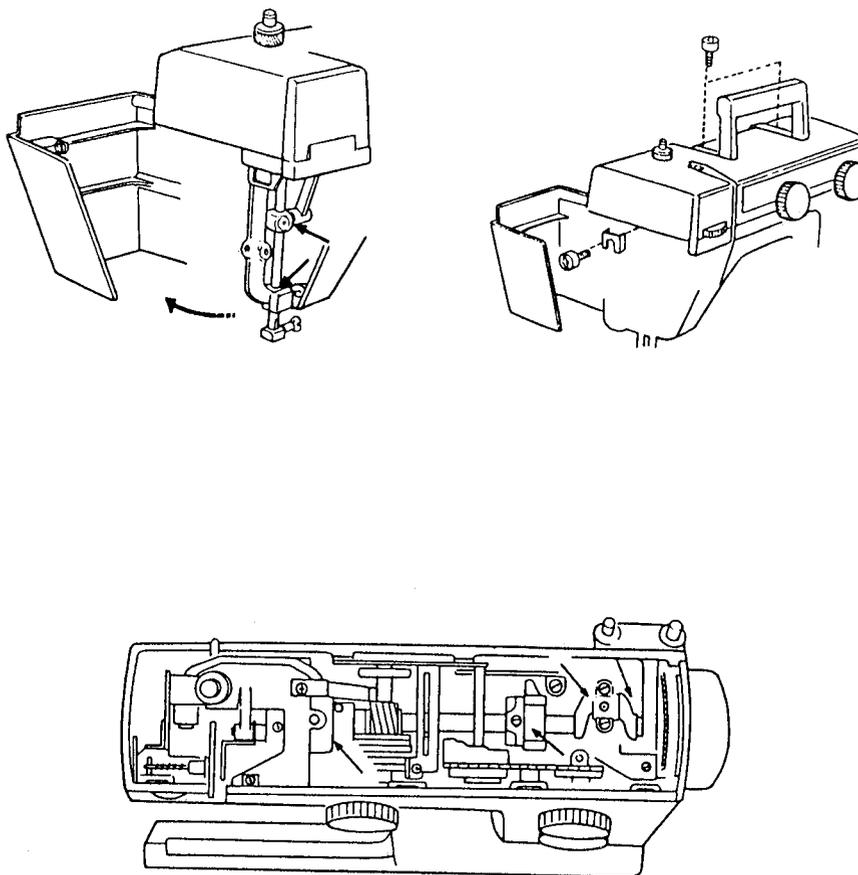
Открыть фронтную доску и поднять ручку для переноса машины. Отвернув три установочных винта, снять верхнюю крышку.
