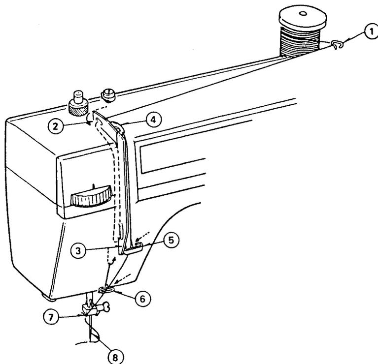
Поворачивая маховое колесо в направлении к себе, поднять нитепритягивательный рычаг.
