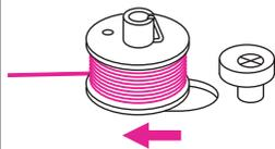
8. После того как, нить закреплена несколькими намотанными слоями, остановите машину и обрежьте кончик нити, который вы придерживали. Затем продолжайте намотку до заполнения шпульки, когда нить наматывается на шпульку в достаточном количестве, скорость намотки уменьшится. Остановите машину и переведите шпиндель в левое положение.
