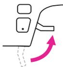
Выключите машинку OFF "O". Поднимите рычаг подъема прижимной лапки.
