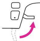
3. Поднимите рычаг подъема прижимной лапки. Выберите строчку.
